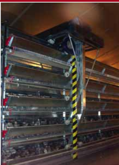
El reparto de pienso con tolva autopulsada, en las baterías de la empresa INSAVI de Reus.
