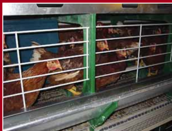
El frente de una jaula MEC, de Zucami, de cómoda apertura deslizable hacia arriba.
