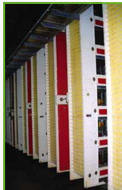
Las norias para elevación de los huevos hasta el transportador de varillas que los conducirá hasta el almacén.
