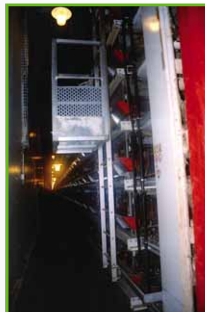
El carro móvil para la observación de las aves de los pisos superiores, en su posición de descanso al inicio de una hilera.
