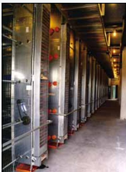
Vista del extremo de las hileras de jaulas en donde se hallan las norias elevadoras de los huevos hasta el transportador transversal, en la parte superior de la foto.
