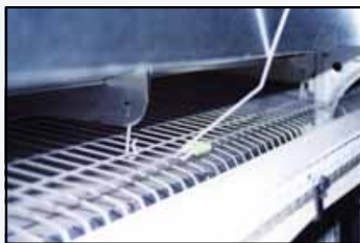
Detalle de la abertura de paso de los huevos, debajo del comedero, con el cable que los retiene momentáneamente.
