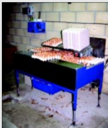
Ponedero longitudinal mecanizado de la firma GURA, en una granja de 1.000 gallinas camperas. A la derecha, mesa recolectora de huevos instalada en el almacén. (Fotos Proavial)
